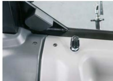
Le débit maximum du distributeur mécanique numéro 3 peut être limité au moyen d'une petite manette en cabine.
